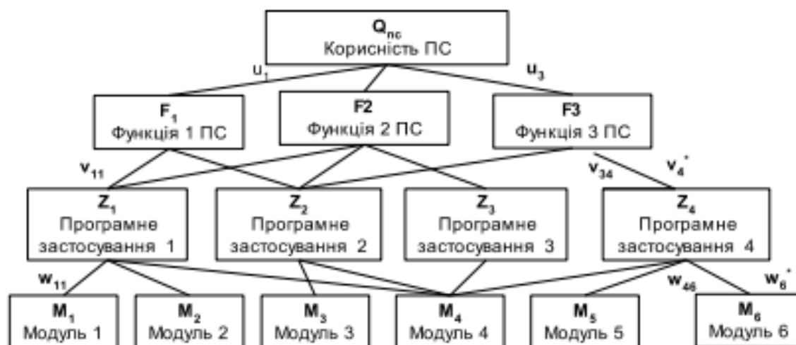
Рисунок 1 – Чотирирівнева ієрархічна структура ПС
