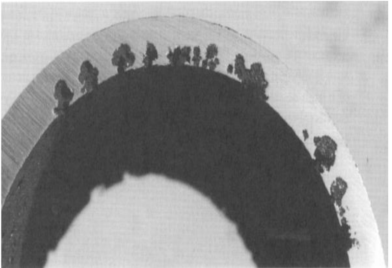
Рис. 1.2. Зразок труби покритий пітинговою корозією
