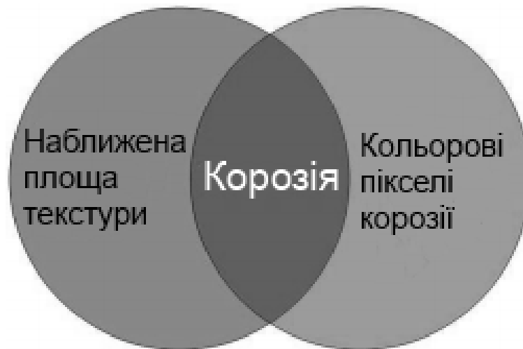
Рис. 1.9. Взаємозв'язок площі текстури та кольорових пікселів корозії на ній
