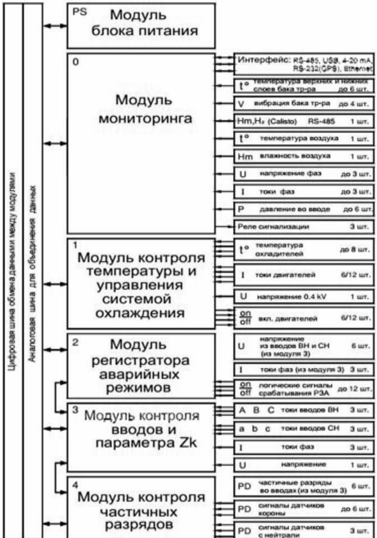
Рисунок 4.3 Блок-схема системы мониторинга і діагностики технічного стану трансформаторного обладнання на базі пристрою „ТДМ”
