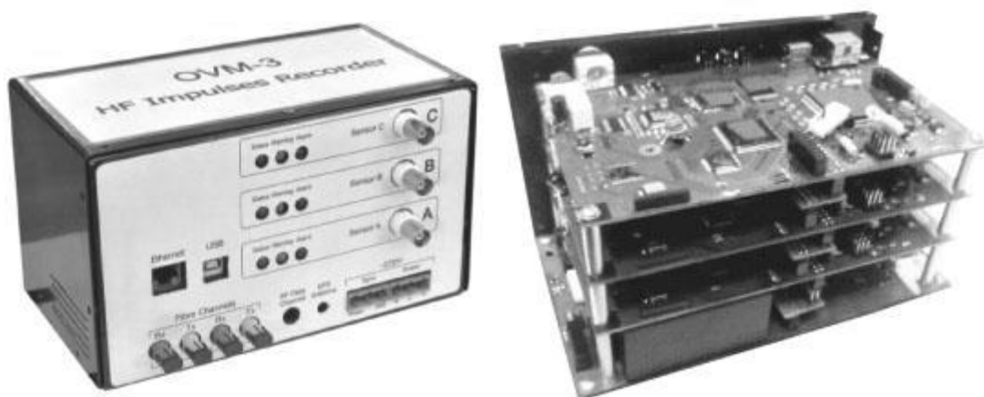
Рисунок 3.3 Зовнішній вигляд приладу OVM-3 для діагностування технічного стану ізоляції
