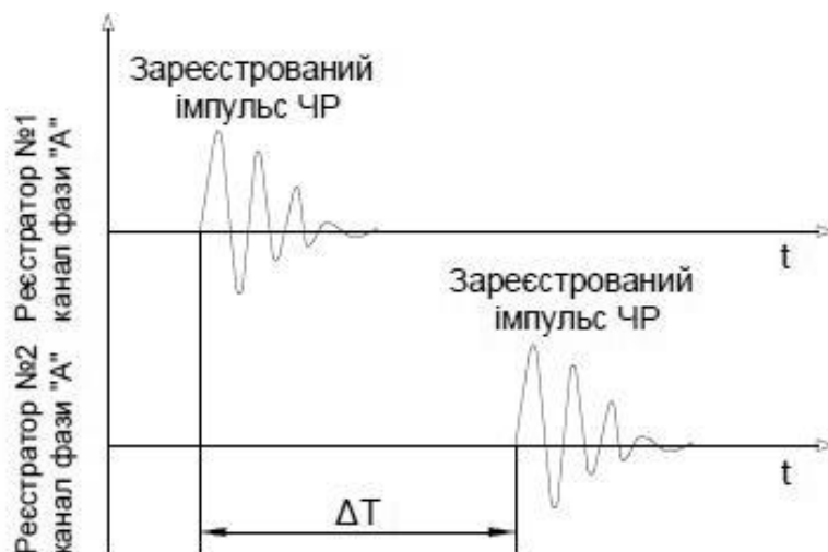
Рисунок 3.2 Реєстрація імпульсів, що виникають внаслідок ЧР.
