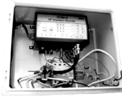
Рисунок 3.4 Прилад OVM-3 у підключеному стані
