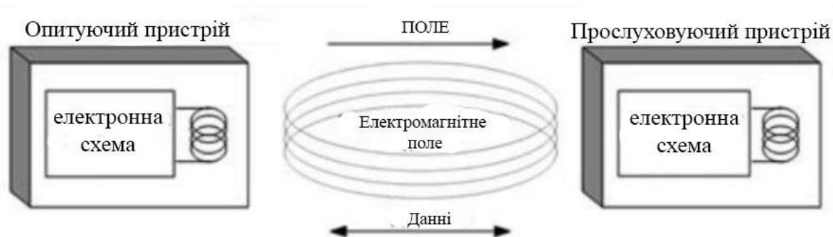
Рис. 1.8. Принцип роботи NFC.
