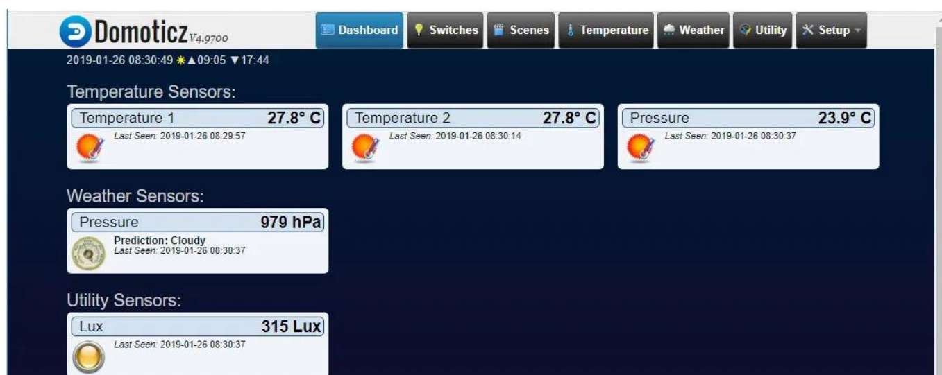
Рис. 2.13. Панель Dashboard з усіма обраними датчиками
