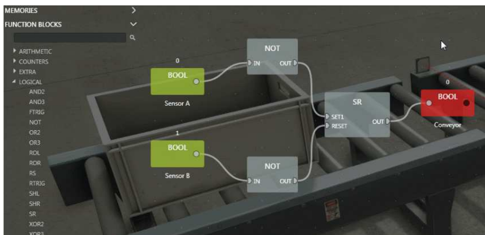
Рисунок 5.21 Готова діаграма з функціональних блоків
