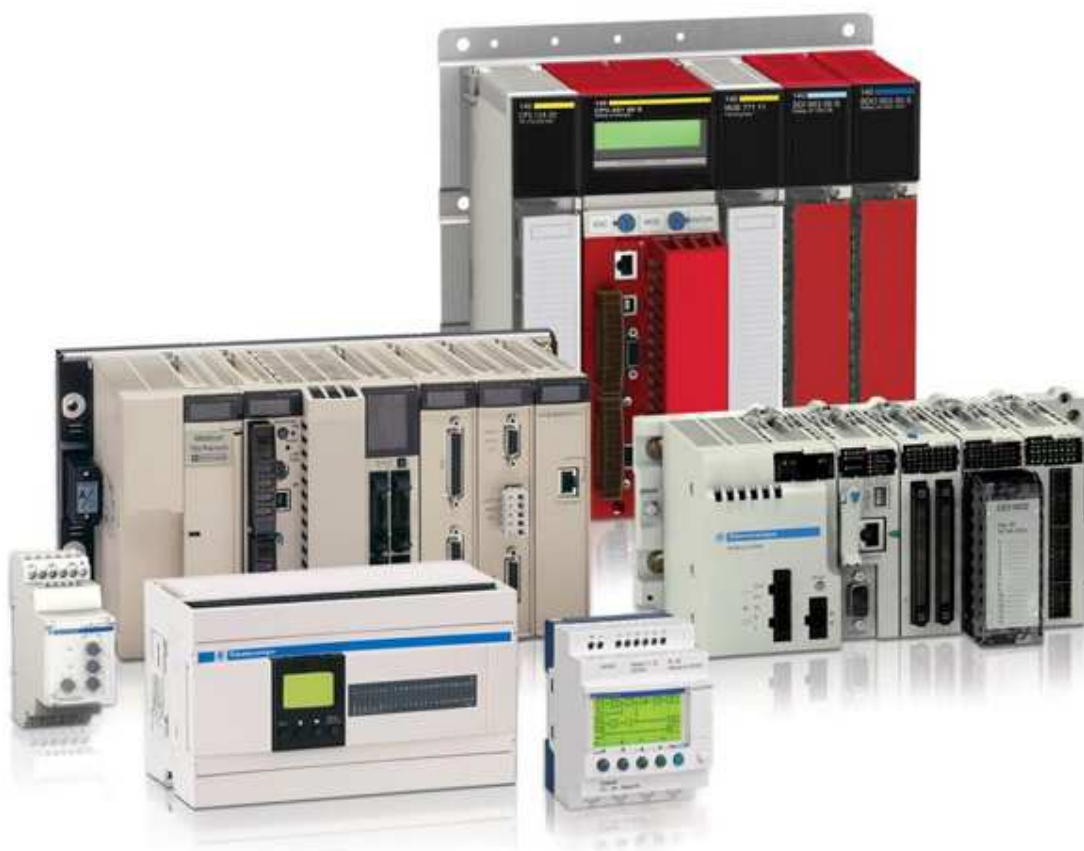
Рисунок 1.5 Модульні програмовані логічні контролери [4]
