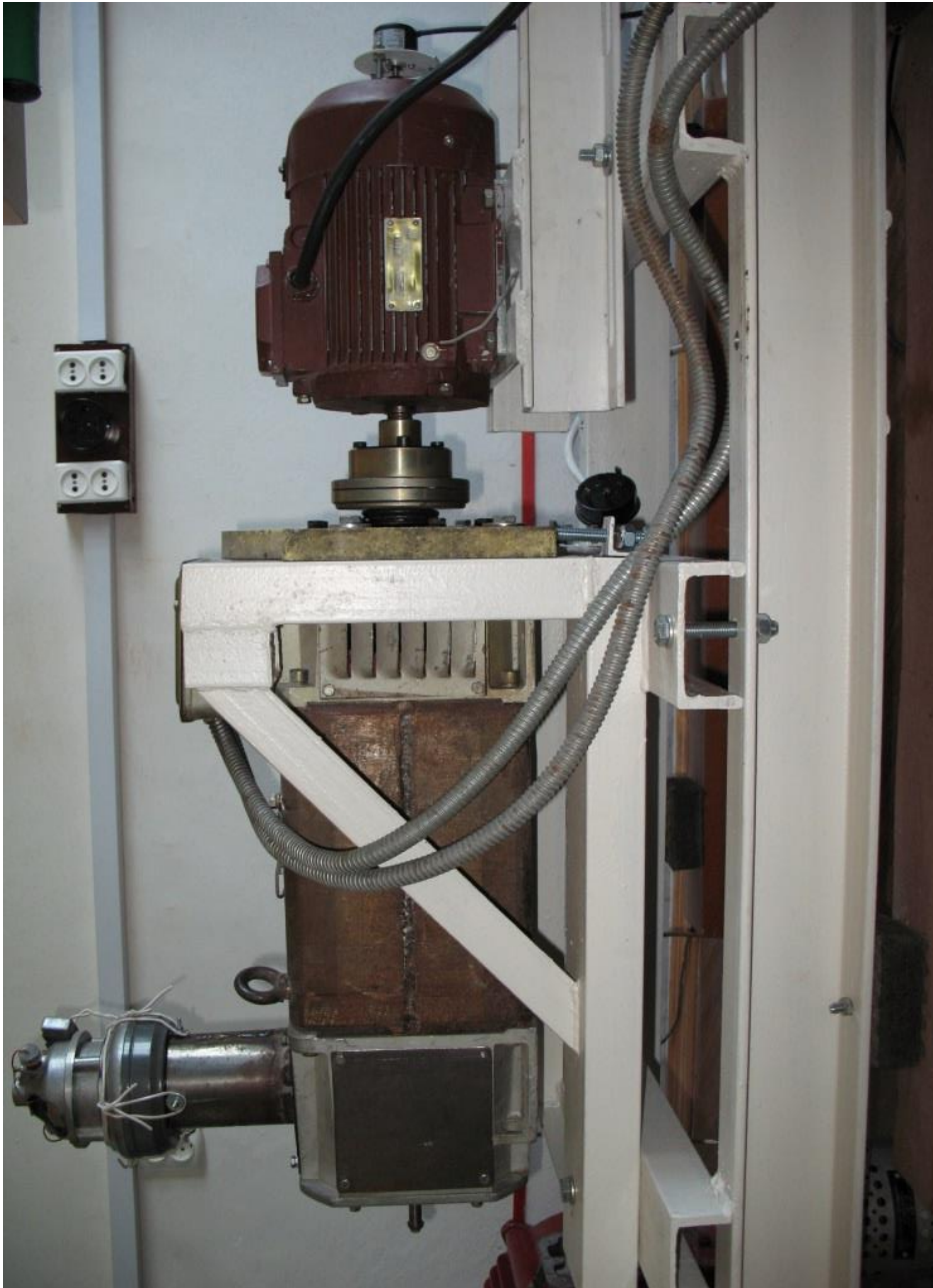
Рисунок 4.3 – Загальний вигляд експериментальної установки для дослідження режимів роботи асинхронного двигуна
