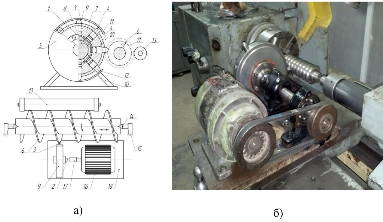
Рис. 3 – Процес зміцнення поверхні гвинтового робочого органу з використанням обкатного інструменту: а) конструктивна схема; б) загальний вигляд
