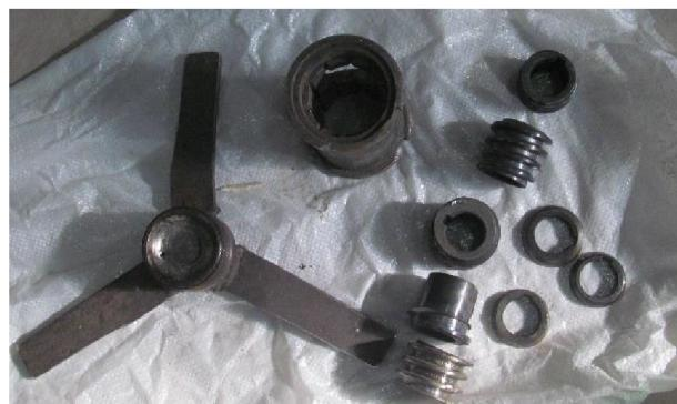
Рис. 2 – Окремі секції шнеків екструдера
