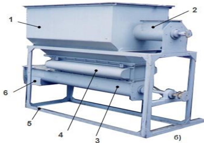
Рис. 3.1. Загальний вигляд просіювача борошна: 1 – корпус; 2 – патрубок приймальний; 3 – корпус вивантажувального шнека; 4 – корпус магнітоуловлювачів; 5 – рама; 6 – вивантажувальний патрубок.
