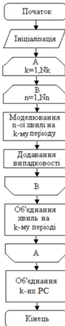
Рис. 3.5. Алгоритм генерування тестового радіосигналу як стохастичного так і повторного
