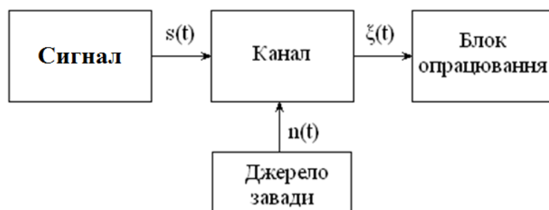
Рис. 1.5. Загальний принцип побудови радіотехнічних систем зв'язку
