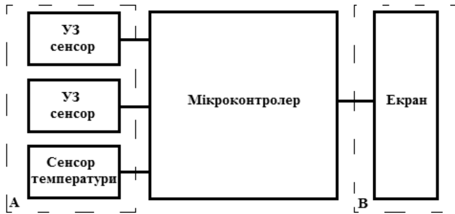
Рисунок 4.1 – Структурна схема мікроконтролерної системи
