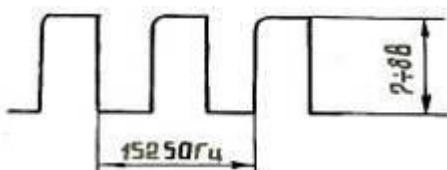
Зображення 16 - Сигнал в КТ8 при вільному обертанні двигуна БВГ
