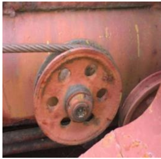
Рис. 1.5. Відновлення палубних механізмів внаслідок корозійного руйнування на суховантажних суднах, за даними проф Мамуні Є.П. та ін.
