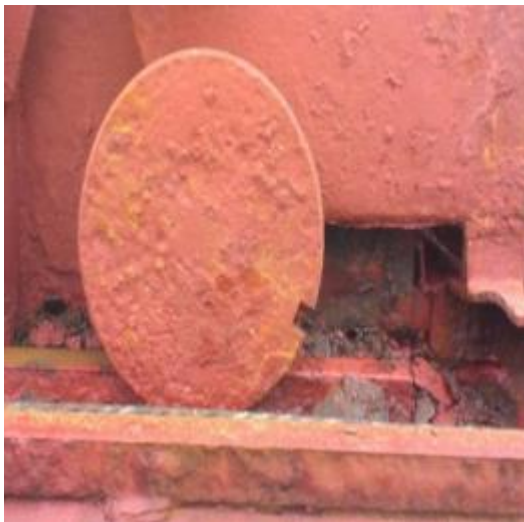
Рис. 1.5. Відновлення палубних механізмів внаслідок корозійного руйнування на суховантажних суднах, за даними проф Мамуні Є.П. та ін.
