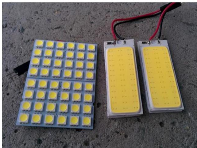
Рис. 1.5. Світлодіодна матриця CDM 5050 (зліва), і COB- матриця із 36 чіпів (справа).
