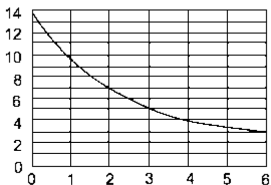
Рис. 4.3 - Залежність теплового опору радіатора від швидкості потоку повітря v (м/с)/
