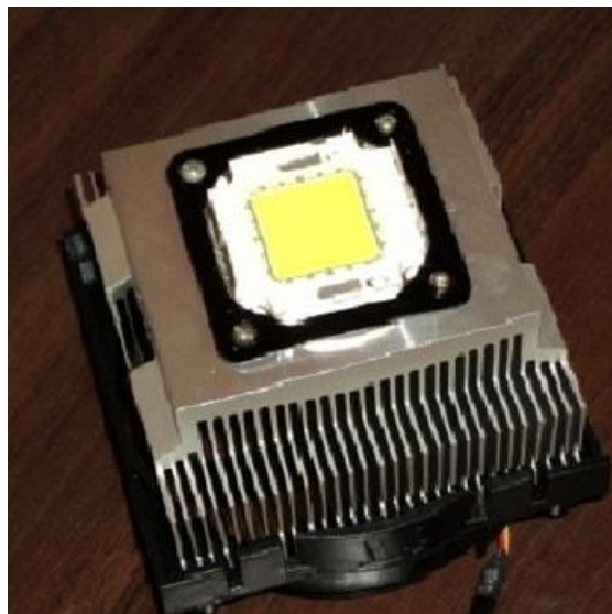
Рис. 4.2 - Конструкція системи охолодження світлодіодної матриці на базі радіатора та вентилятора
