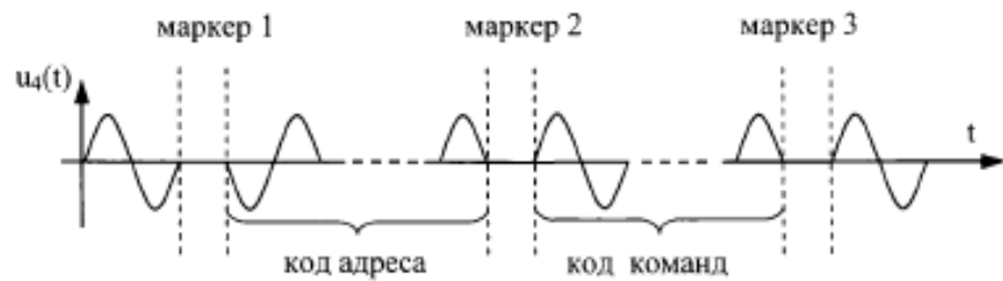
Рисунок 5.11 - Епюра напруги на виході комутатора при передачі адресною команди управління
