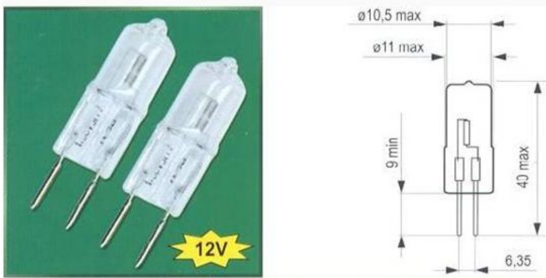
Рис. 4 Загальний вигляд і геометричні розміри галогенної лампи.
