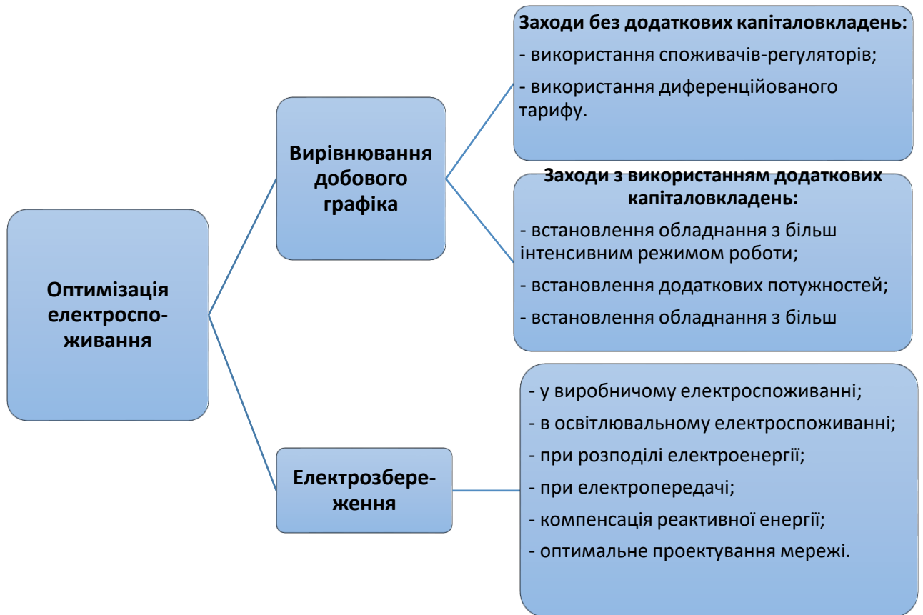
Рисунок 1.1 – Структура енергоефективної системи електропостачання кормоцеху
