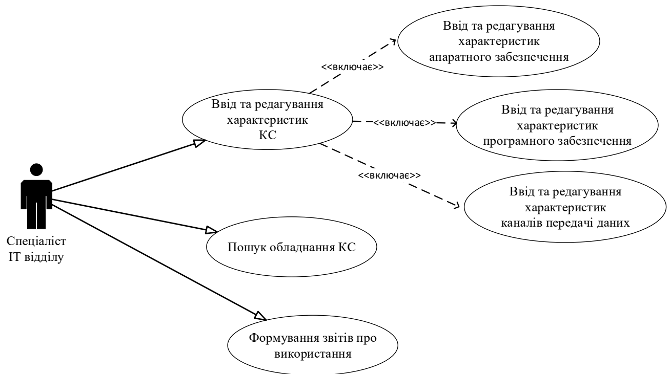
Рис. 3.1. Діаграма варіантів використання для визначення функціональних можливостей спеціаліста ІТ відділу
