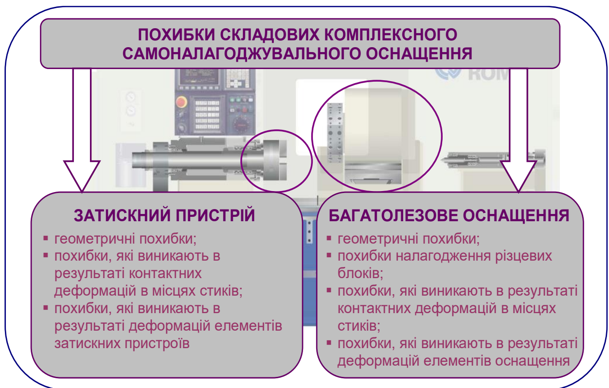
Рис. 2.5. Структура похибок складових комплексного самоналагоджувального оснащення для токарної обробки
