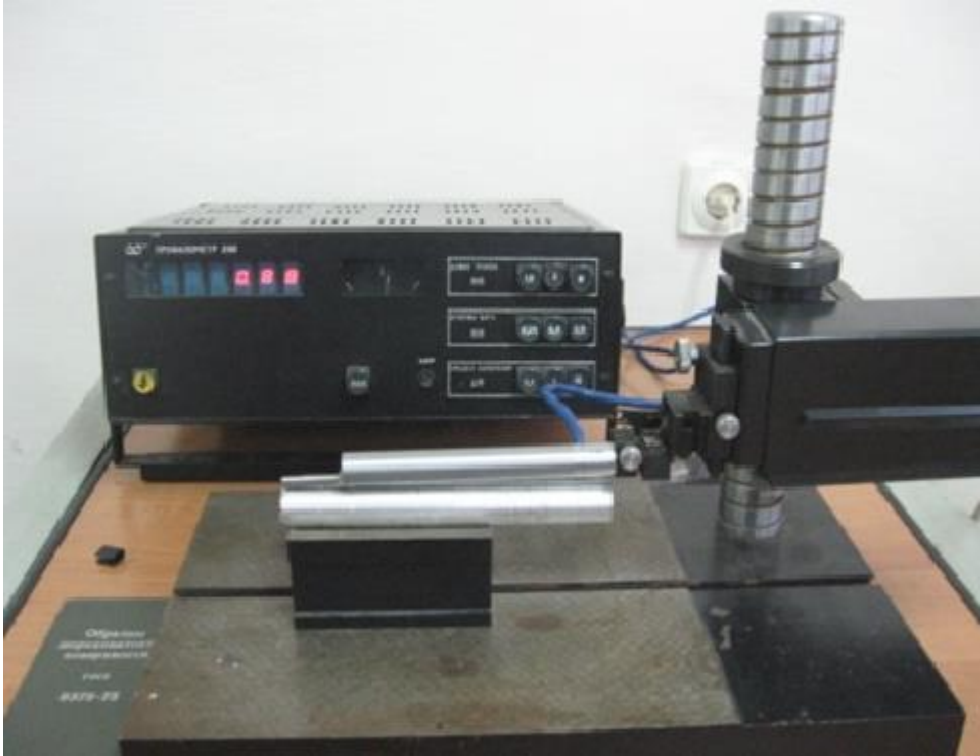
Рис. 4.4. Профілометр-профілограф мод.296 для отримання профілограф
