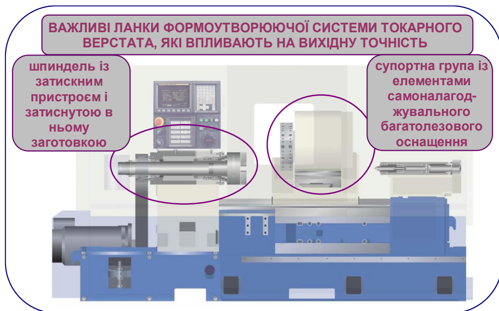
Рис. 2.4. Ланки формоутворюючої системи токарного верстату із комплексним самоналагоджувальним оснащенням
