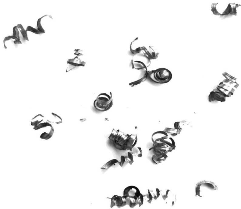
Рис. 4.15. Фотографія фрагментів утворюваної стружки
