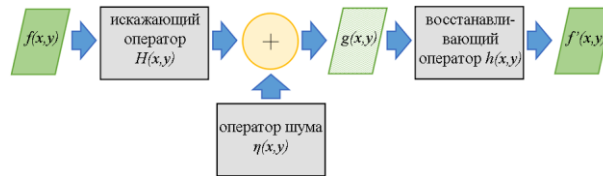
Рис. 1. Стандартная модель процесса искажения/восстановления изображения
