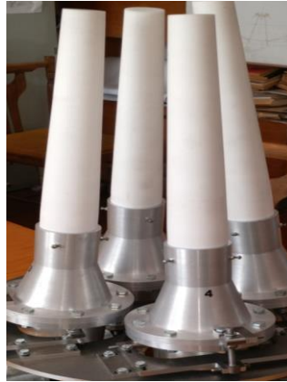
Рис. 4. Чотириканальний опромінювач на основі фазованої градки
