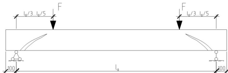
Рисунок 1 – Схема дослідження похилих перерізів залізобетонних балок
