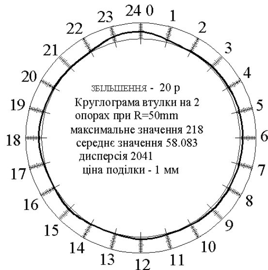
Рисунок 4.10 Усереднена круглограма згортної втулки сформованої при радіусі транспортного каналу R=50 мм і способі базування ФМ – оправка на 2-х опорах
