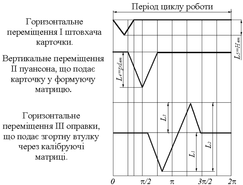
Рисунок 2.10 Циклограма роботи пристрою для згортки втулки
