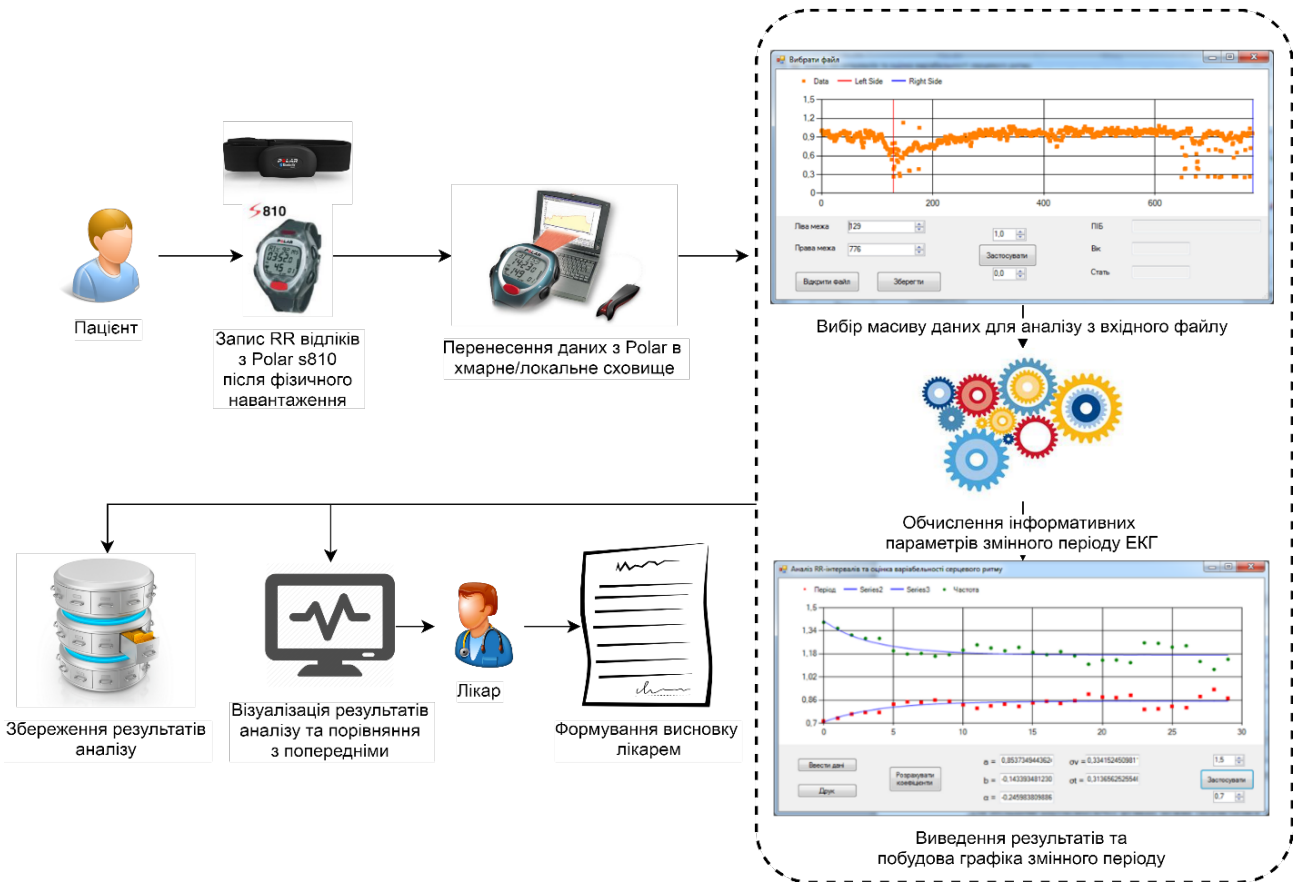
Рисунок 10 – Структурна схема інформаційної технології оцінювання змінного періоду ЕКГ та визначення діагностичних ознак варіабельності серцевого ритму
