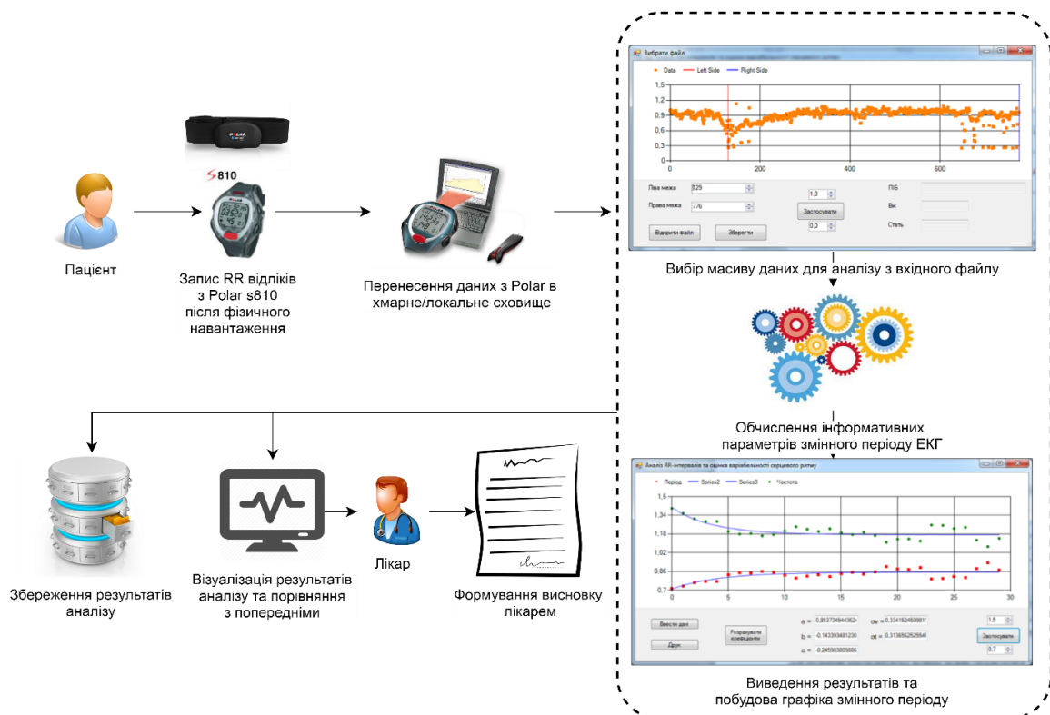
Рисунок 4.21 – Структурна схема інформаційної технології оцінювання змінного періоду ЕКГ та визначення діагностичних ознак варіабельності серцевого ритму
