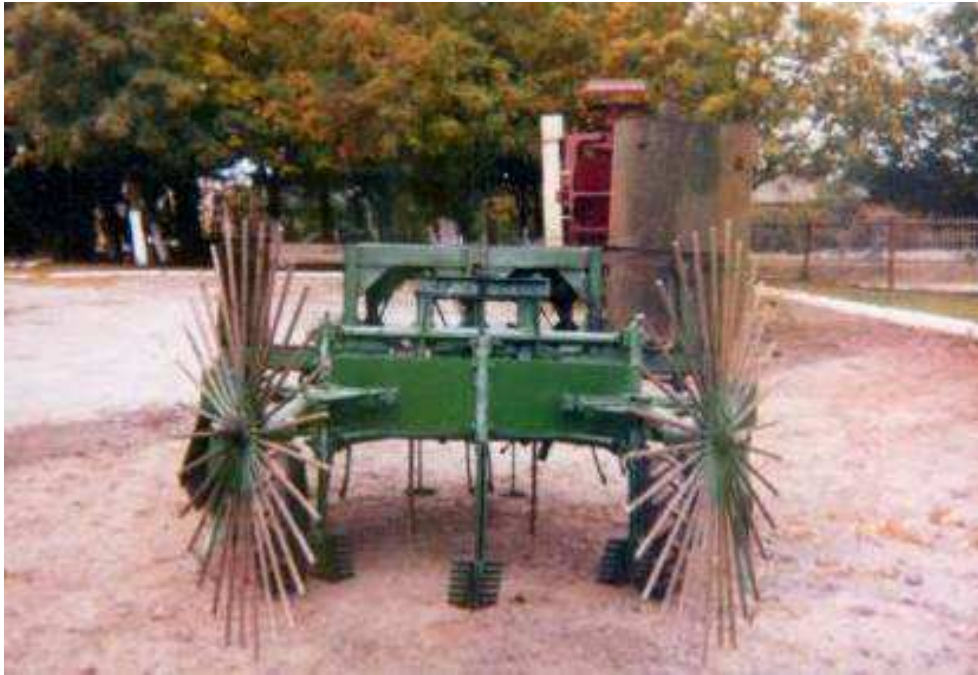
Рисунок 3 – Машина для викопування і очищення коренеплодів зі складанням їх у центральний валок
