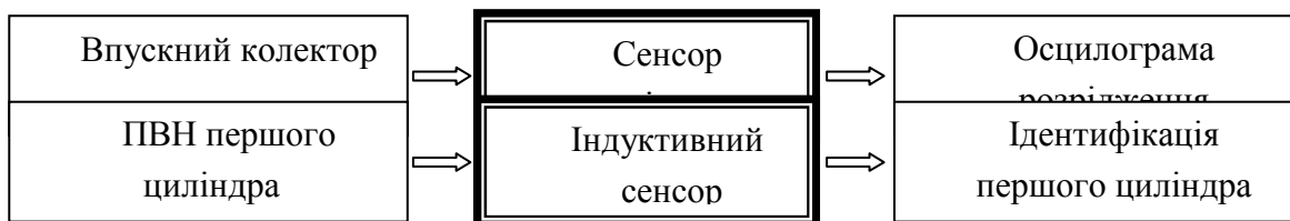
Рисунок 1 - Схема приєднання сенсорів
