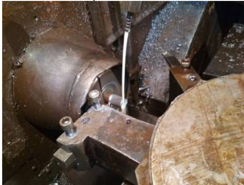
Рисунок 2. Реализация процесса изготовления насадки на станке с ЧПУ
