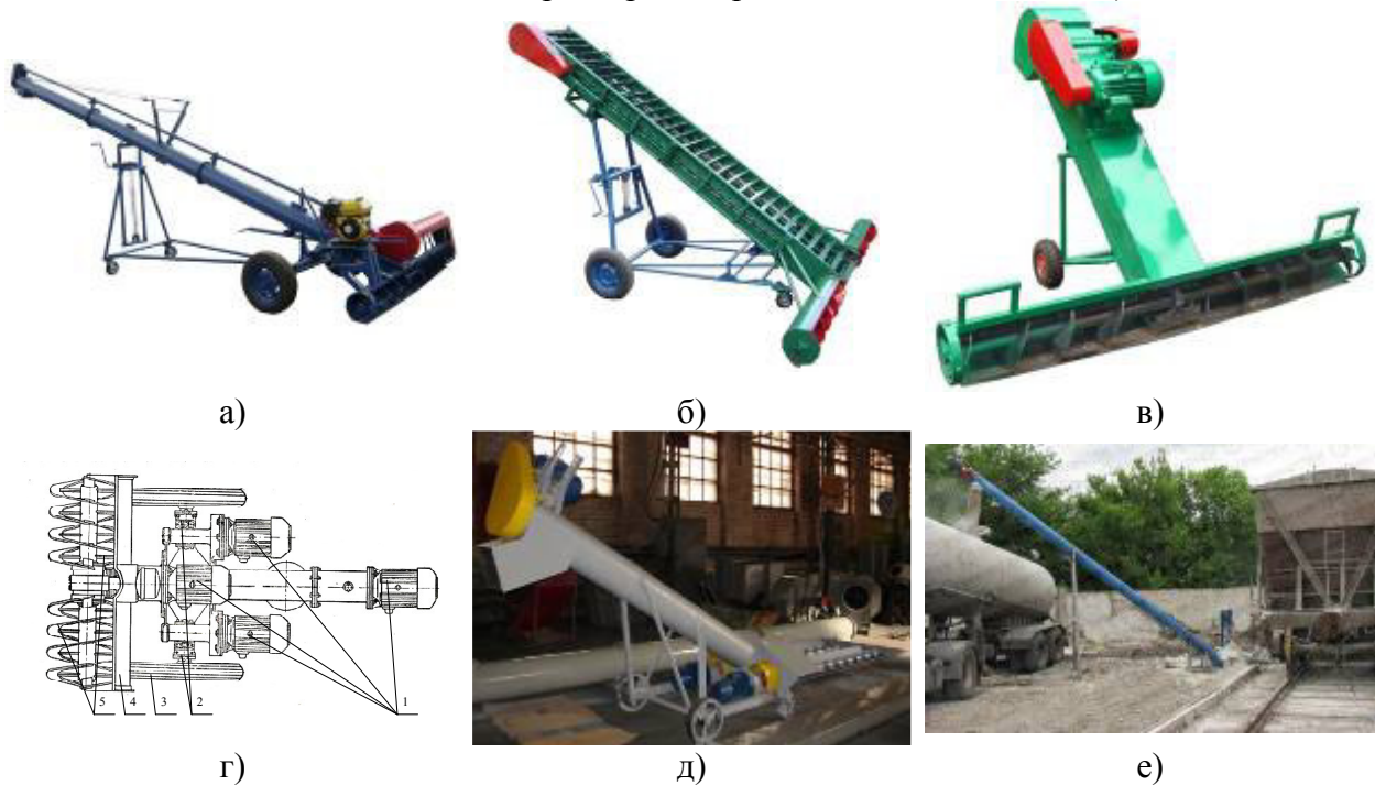
а) б) в) г) д) е) Рисунок 3. Завантажувальні пристрої: а) завантажувач шнековий (ООО «Гарант-Агро», м. Кривий Ріг, http://garantagro.com/ ); б) скребково-шнековий транспортер (ООО «Гарант-Агро», м. Кривий Ріг, http://garantagro.com/ ); в) шнек підбору з землі зернових і технічних культур у вигляді приставки для завантаження транспортерів шнекових, стрічкових, норій (ООО «Гарант-Агро», м. Кривий Ріг, http://garantagro.com/ ); г) шнековий забірний візок [2]; д) гвинтовий розвантажувач вагонів (хоппер) У9-РХ-61 в роботі (ПАТ «ЕКВІПТЕХ» м. Дніпропетровськ, www.ekvipteh.com.ua/ ); е) гвинтовий розвантажувач вагонів У9-РХ-61 в роботі
