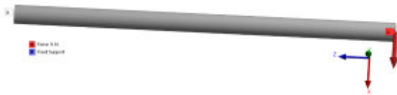
Рисунок 1. Прикладена сила А і закріплення В
