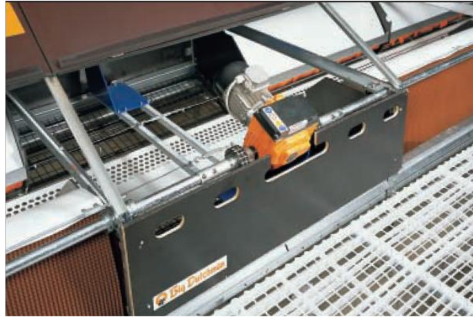
Рис. А.2. Зовнішній вигляд двигуна для закривання і відкривання гнізда
