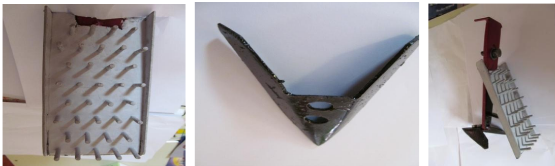
Рис. 3.17. – 3.19. Розподільча пластина, лапка-бритва розрівнювання борозни підшви ґрунту, стояк, на якому кріпляться лапка-бритва та розподільча пластина експериментального дискового сошника.
