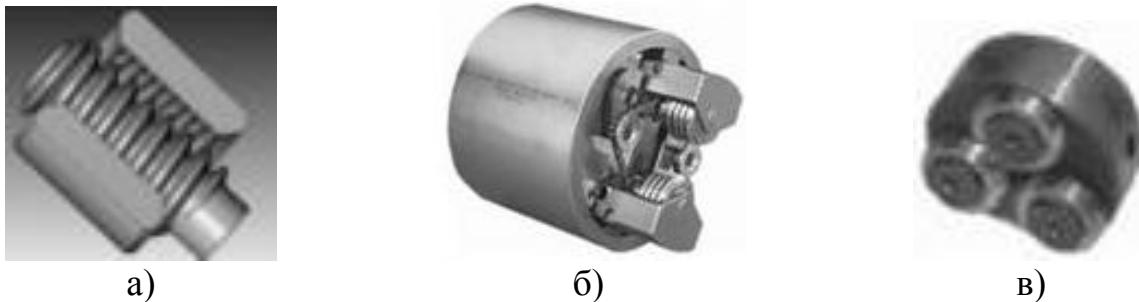
Рис. 1.5 – Інструмент для накатування різі: а) ролик для розкочування внутрішньої різі; б) різьбонакатна головка; в) різьбонакатні плашки
