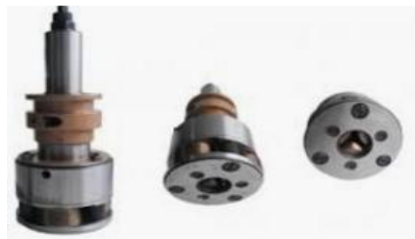
Рис. 1.3 – Різьбонарізні головки: а) для нарізання внутрішньої різі; б) для нарізання зовнішньої різі
