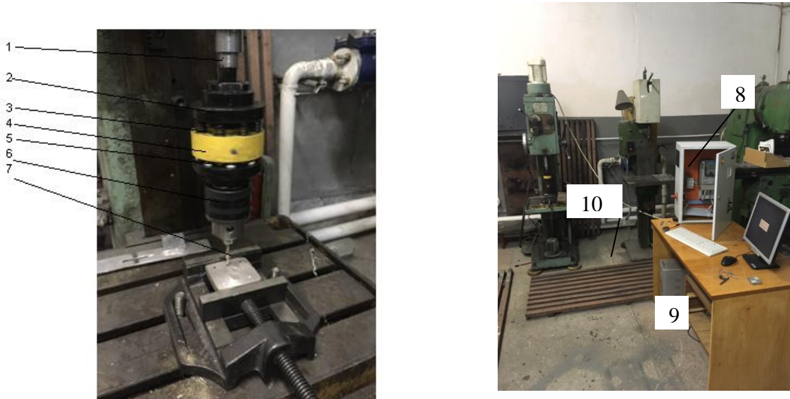
Рис. 13. Загальний вигляд експериментальної установки : 1 – хвостовик; 2 – верхня кришка; 3 – демфуючі пружини; 4 – основа; 5 – кульки; 6 – патрон; 7 – свердло-мітчик; 8 – керуючий пристрій Altivar 71; 9 – комп’ютер; 10 – комутаційне з’єднання
