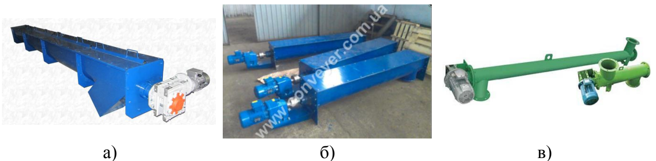
Рис. 1.2. Загальний вигляд горизонтальних ГК: а) ТОВ «Технік» (Україна); б) ПАТ «Конвеєр» (Україна); в) ООО «Компания Механик» (Росія)
