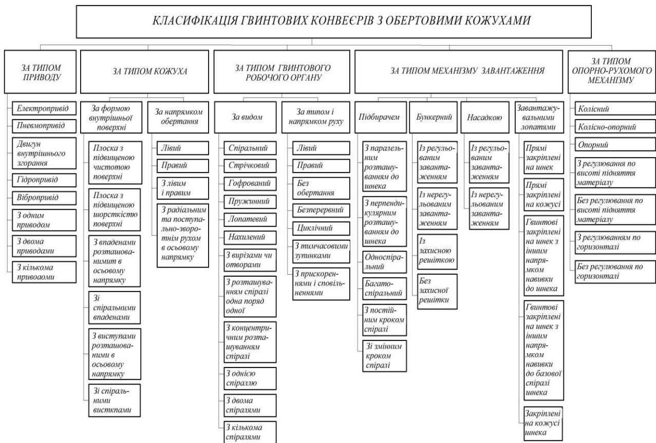
Рис. 2.3. Класифікація гвинтових конвеєрів з обертовими кожухами за конструктивними ознаками
