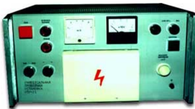
Рис. 7 Установа для високовольтних випробувань УПУ-21
