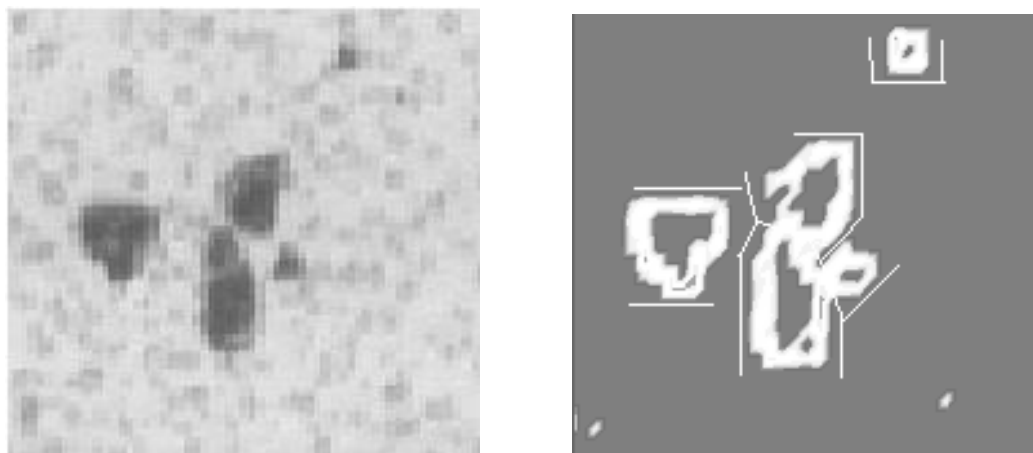
Рис. 5.28. Фото (зліва) зразка тонкої плівки епоксикомпозиту з наповнювачем феритом марки 1500 НМЗ із дисперсністю 63мкм в якості наповнювача та діаграма візуалізації (справа) з допомогою оператора максимального градієнту зовнішніх поверхневих шарів часток фериту цього ж зразка. Межі комірок поширення шарів зображено тонкими лініями
