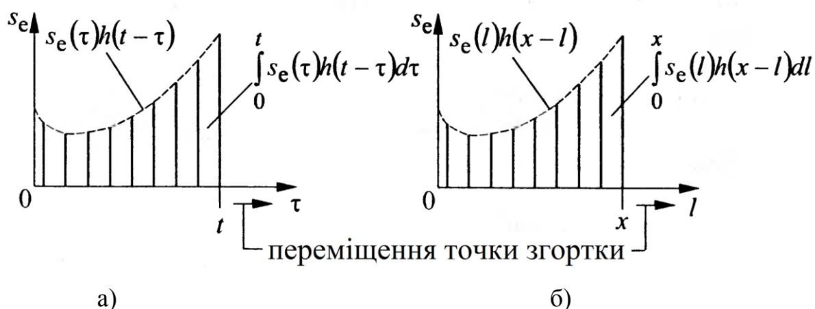
Рис. 3.10. Формування інтегралу згортки для часового (а) та просторового (б) сигналів.
