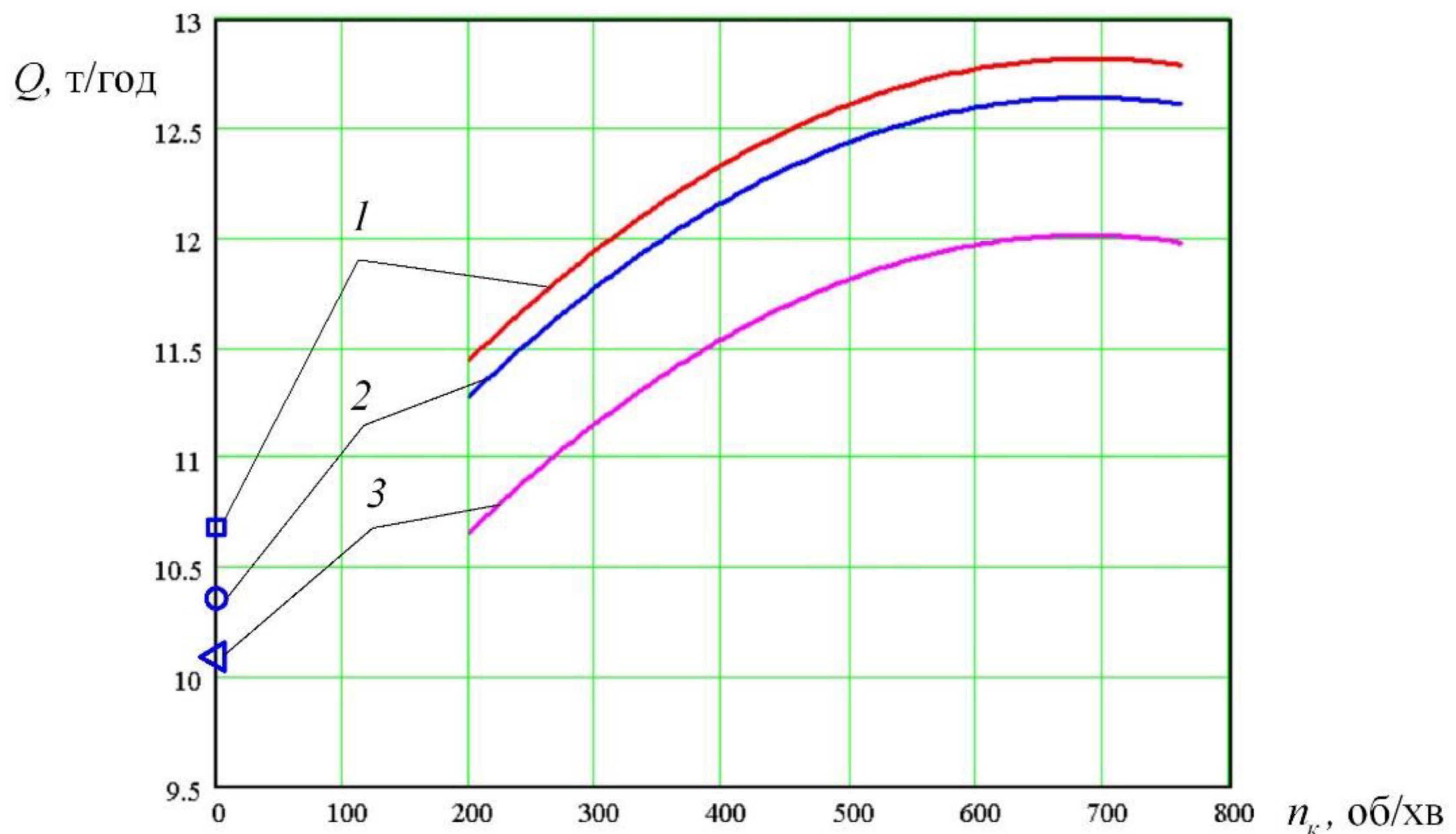
Рис. 2 – Графіки залежності продуктивності гвинтового конвеєра від частоти обертання кожуха конвеєра під час транспортування кукурудзи (діаметр шнека  $D=96\text{мм}$ ; частота обертання шнека  $n=700$  об/хв.): 1)  $\gamma=14$  град; 2)  $\gamma=25$  град; 3)  $\gamma=36$  град
