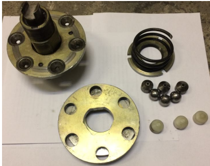
Рис. 3. Видяк пружно - запобіжної муфти в розібраному вигляді
