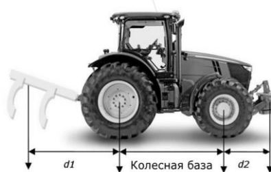
Рис.1 – Перерозподіл експлуатаційної ваги трактора з навісним знаряддям
