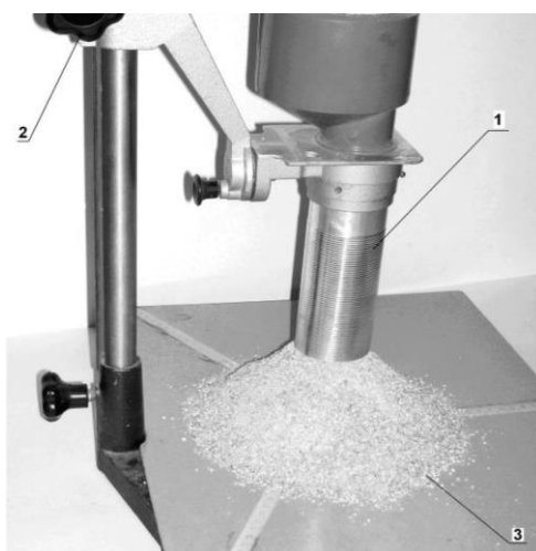
Рис. 3 – Прилад для визначення кутів природного укосу сипучих матеріалів: 1 – порожнистий циліндр; 2 – механізм піднімання циліндра; 3 – площина з розміткою
