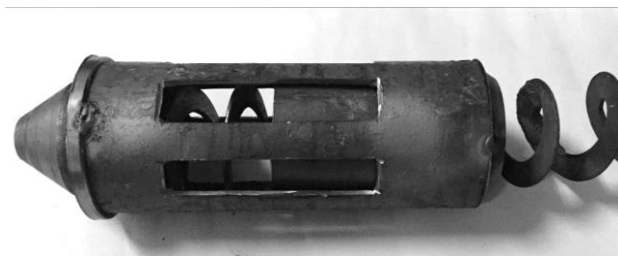
Рис. 5 - Загальний вигляд завантажувально-захисної насадки гнучкого гвинтового конвеєра
