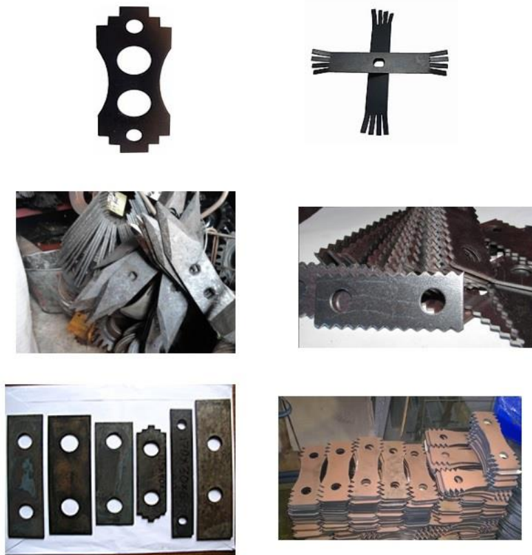
Рис 3 – Сучасні види молотків зернових дробарок
