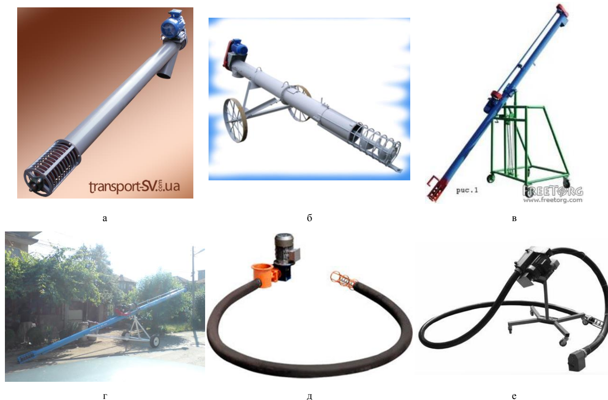
Рис. 1 - Гвинтові конвеєри із завантаженням через насадки
