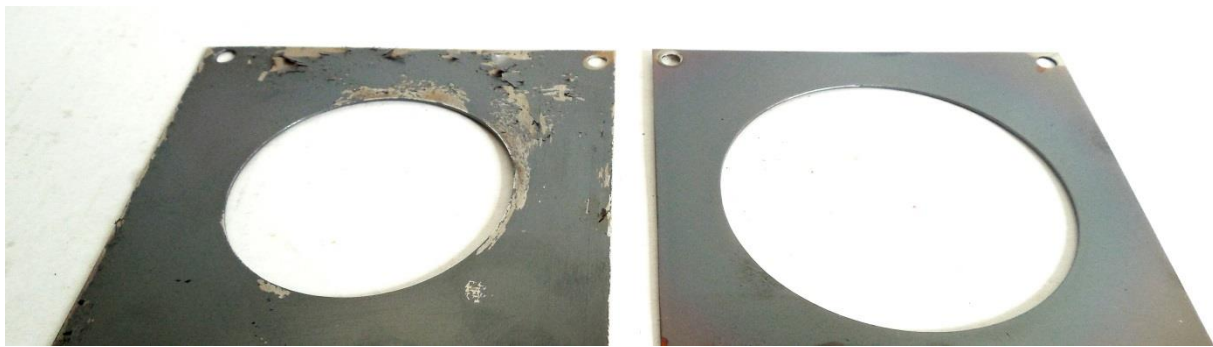
Рис. 1. Покриття AlN-SiC на сталі з поганою і хорошою адгезійною міцністю
