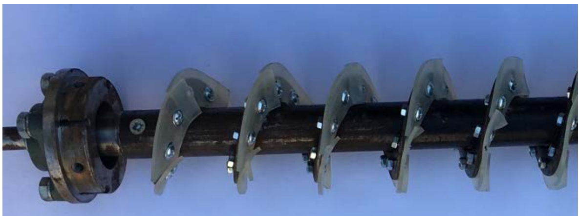
Рис. 5.6. Секційна еластична спіраль (матеріал “поліуретан PU-60”), яка закріплена на жорсткому гвинтовому ребрі
