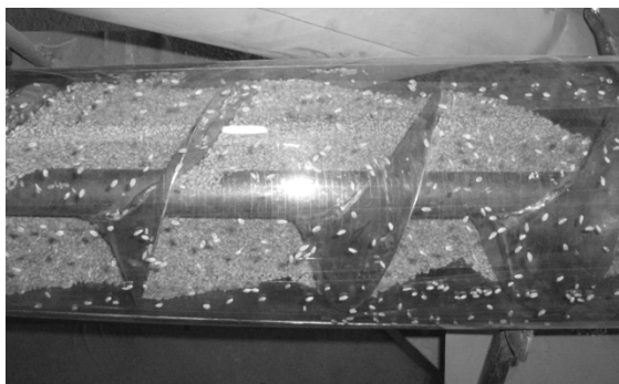
Рис. 1.26. Рух зернового матеріалу в гвинтовому конвеєрі
