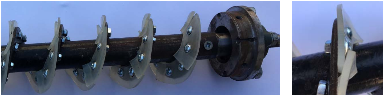
Рис. 3.3. Загальний вигляд шнека з перекриттям еластичних секцій
