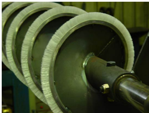
Рис. 1.24. Шнековий гвинтовий робочий орган австралійської компанії «Bulknet» з периферійною поверхнею у вигляді еластичних щіток
