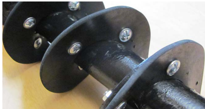
Рис. 5.5. Суцільна гумова еластична спіраль, яка закріплена на жорсткому гвинтовому ребрі
