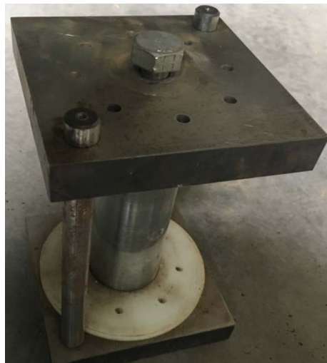
Рис. 5.2. Кондуктор для свердління спіралі шнека, навитою на ребро
