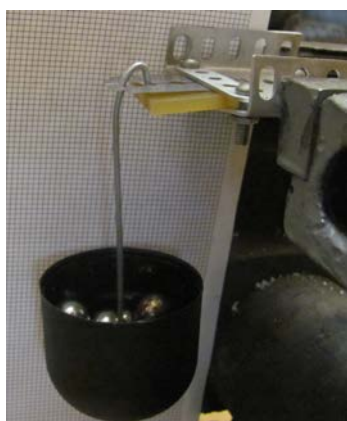
Рис. 3.5. Пристрій для визначення впливу на величину деформації “ \Delta ” секції еластичної секції від її ширини “ B ” та консольного виступу “ h ”
