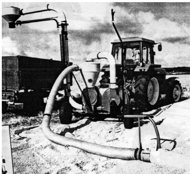
Рис. 1.10. Схема роботи пневмотранспортера фірми «Riela» в польових умовах
