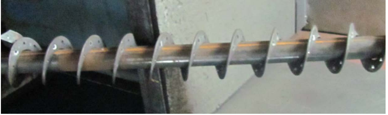
Рис.5.4. Калібрування спіралі на вал
