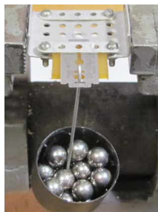
Рис. 3.5. Пристрій для визначення впливу на величину деформації “ \Delta ” секції еластичної секції від її ширини “ B ” та консольного виступу “ h ”
