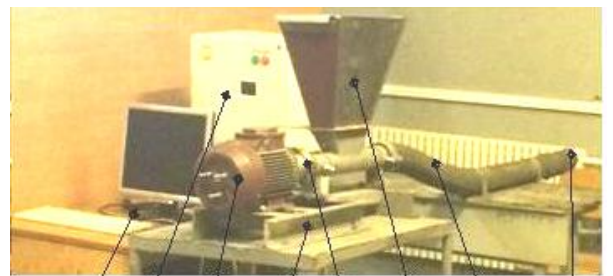
Рис. 8. Завантажувально-захисна насадка гнучкого гвинтового конвеєра: а) конструктивна схема: 1 – наконечник, 2 – насадка, 3 – спіраль, 4 – втулка, 5 – кожух, 6 – отвори просипання; б) загальний вигляд
