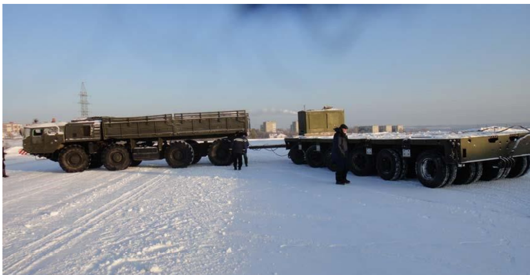
Рис. 3.6. Виконання маневру «Поворот з мінімальним радіусом» під час тестового попереднього заїзду [42]
