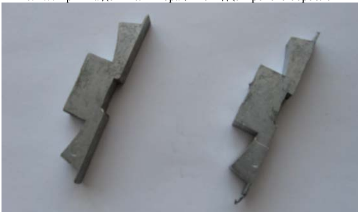
Рис. 4.8. Фіксатор до і після вібраційно-відцентрового оброблення
