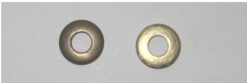
Рис. 4.11. Шайба до і після вібраційно-відцентрового оброблення
