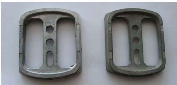
Рис. 4.7. Кришка до і після вібраційно-відцентрового оброблення
