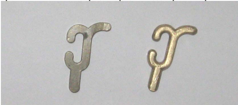
Рис. 4.10. Ручка до і після вібраційно-відцентрового оброблення
