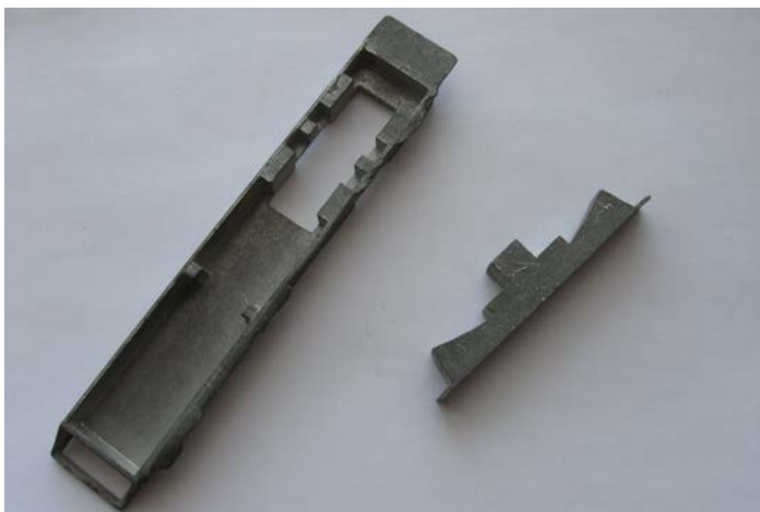
Рис. 4.8. Фіксатор до і після вібраційно-відцентрового оброблення
