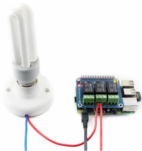
Рис.1. Модуль Raspberry Pi 3 моделі В, що керує вмиканням джерела світла, в охоронній системі «SafeHome»
