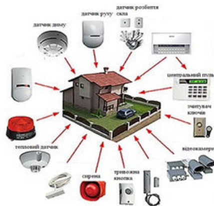
Рисунок 1.1 – Складові системи захисту «розумного будинку»
