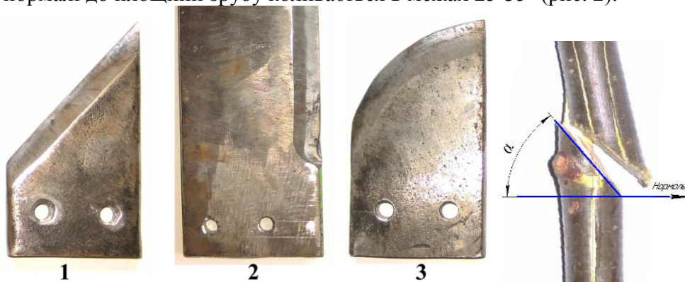
Рисунок 1. Експериментальні ножі: 1) косий ніж з кутом установки 45^{\circ} ; 2) прямий ніж; 3) ніж виконаний з різальною кромкою по радіусу
