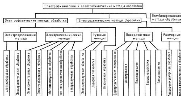
Рисунок 1. Класифікація електрохімічних, електрофізичних і комбінованих методів обробки.
