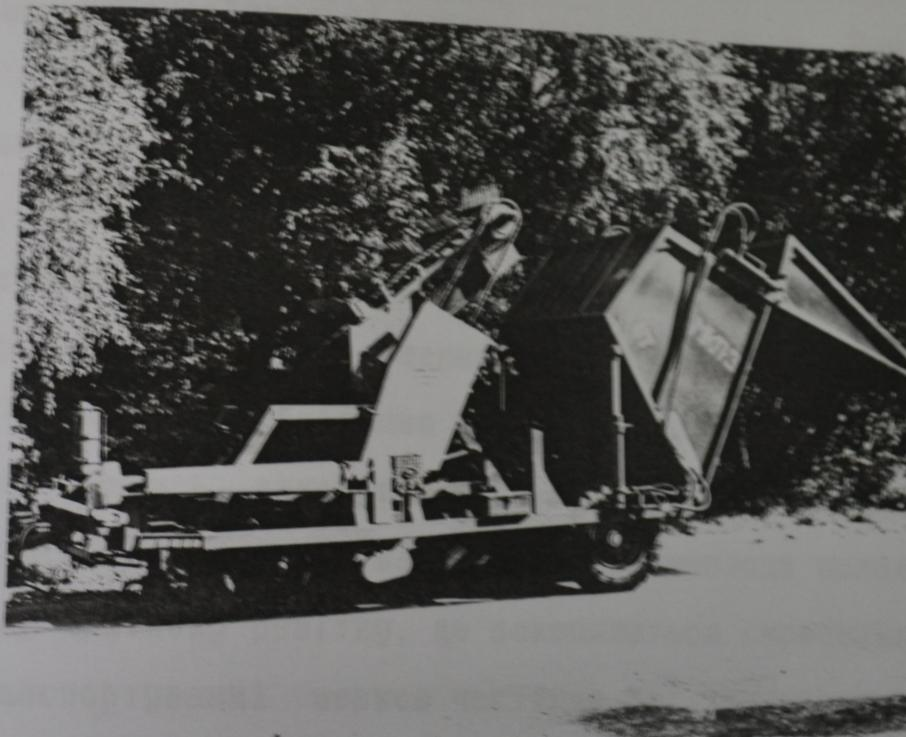
Рис. 4. II Експериментальна причіпна бункерна коренезбиральна машина МКП-З
