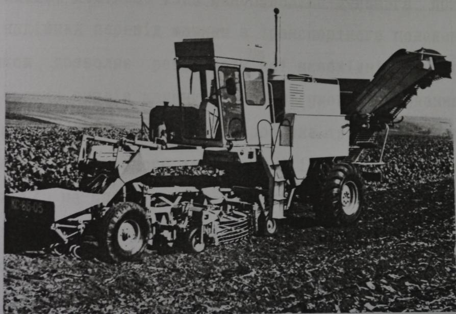
Рис.4.10 Самохідна коренезбиральна машина КС-6Б-05 з трироторним сепаруючим пристроєм
