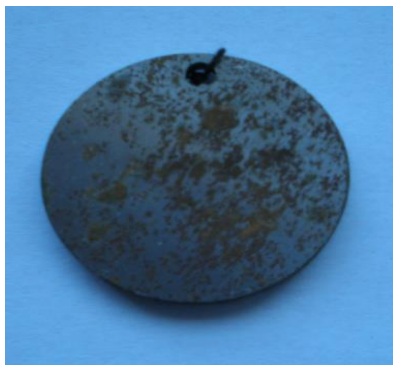
Рис. 2. Зразок (сталі 20) після експозиції протягом 24 діб в сульфаті амонію
