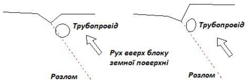
Рис. 2 – Схема деформацій трубопроводів на зонах розлому
