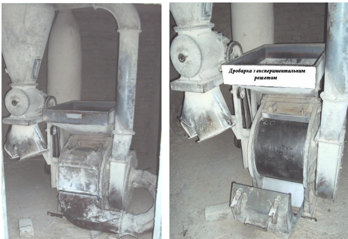
Рис. 4.11. Універсальна дробарка для подрібнення кормів КДУ – 2,0: а) загальний вигляд; б) розміщення експериментального решета у подрібнювальній камері.
