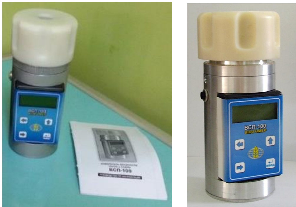
Рис. 3.9. Прилад для визначення вологості зернового матеріалу ВПС-100.
