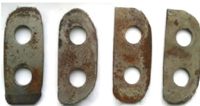
Рис. 1.11. Втрата форми і маси молотків дробарки при спрацюванні
