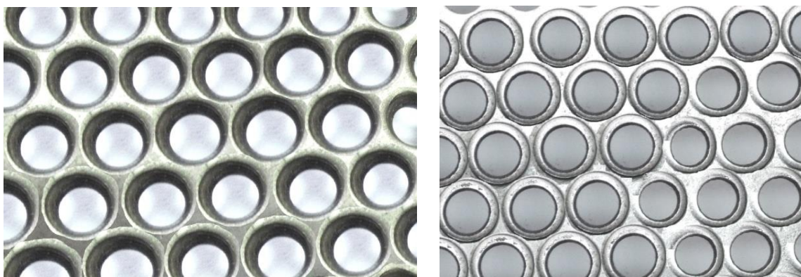
Рис. 4.12. Експериментальне решето з отворами тороїдальної форми:
