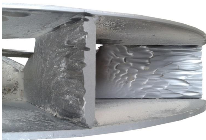
Рис. 1.10. Зношене колесо вентилятора
