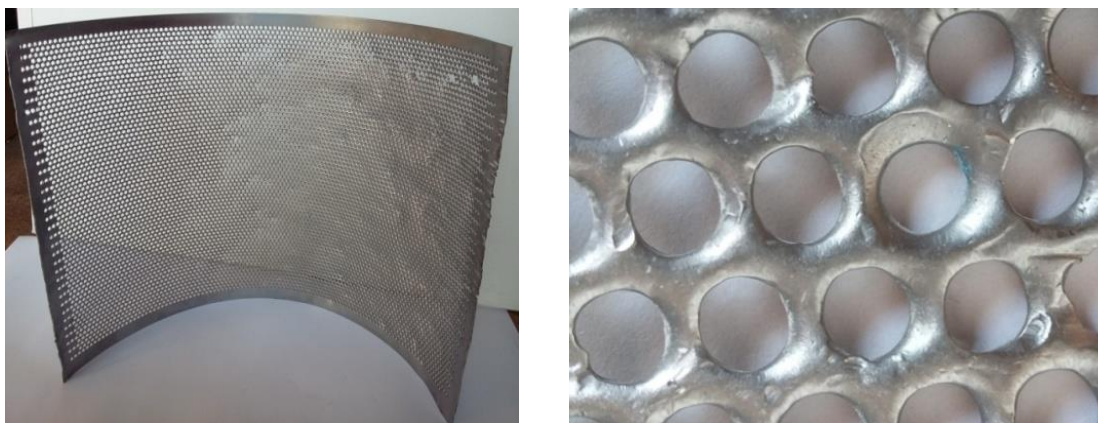
Рис. 4.20. Зношене експериментальне решето: а – загальний вигляд; б – фрагмент зношеної поверхні.
