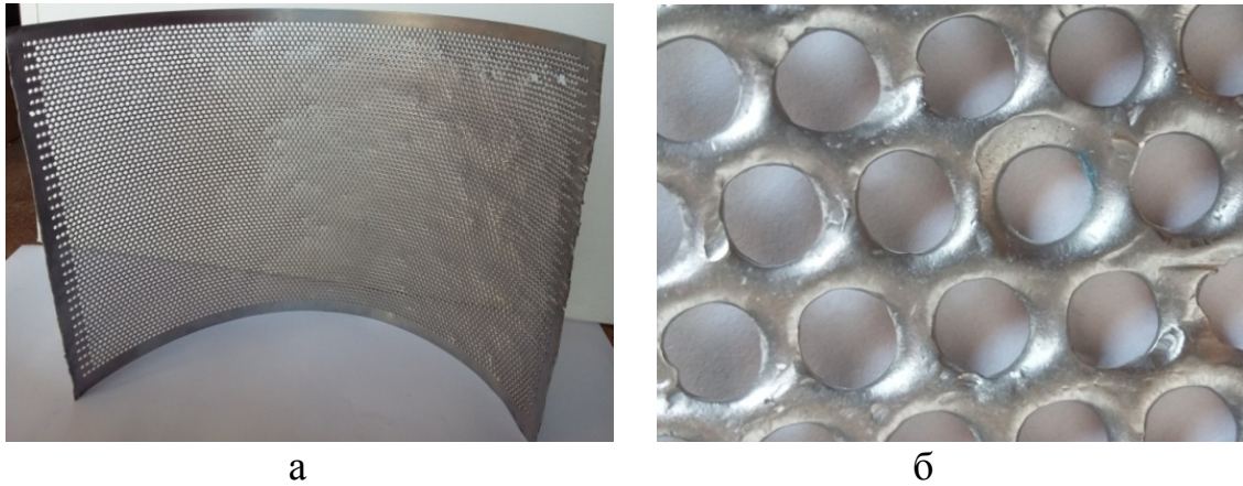
Рис. 15. Зношене експериментальне решето: а – загальний вигляд; б – фрагмент зношеної поверхні.
