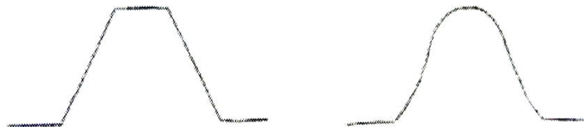
Рис. 3. Трапецієподібний і дзвоноподібний імпульси
