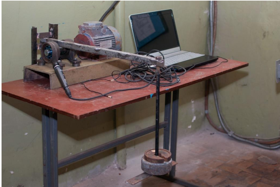
Рис. 1. Лабораторна установка шумо-діагностичного контролю підшипників кочення
