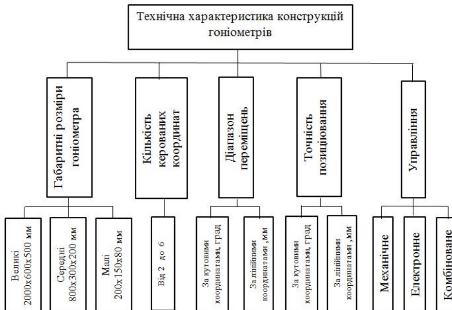
Рис. 1. Класифікація конструкцій гоніометрів
