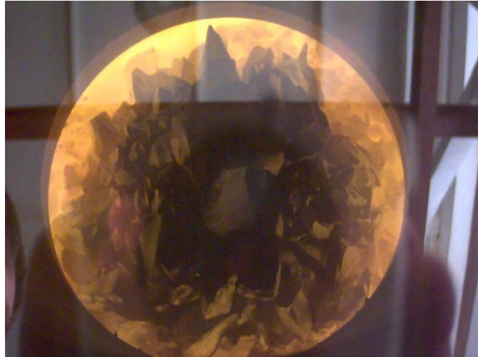
Рис. 2. Дендритна структура робочої лопатки, отриманої на установці УВНК-8П (м. Запоріжжя, «Мотор Січ»).
