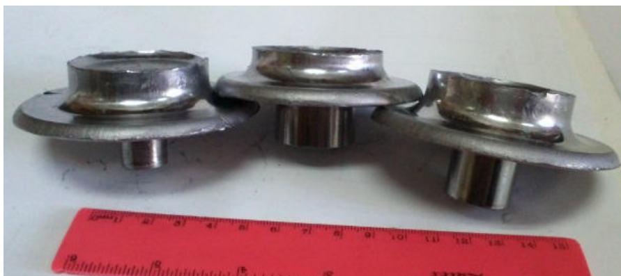
Рис. 1. Дослідні деталі, що отримані комбінованим видавлюванням
